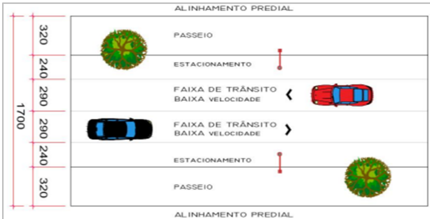
Figura 03: Dimensionamento para Vias Locais. Fonte: LC nº 338/2020.
