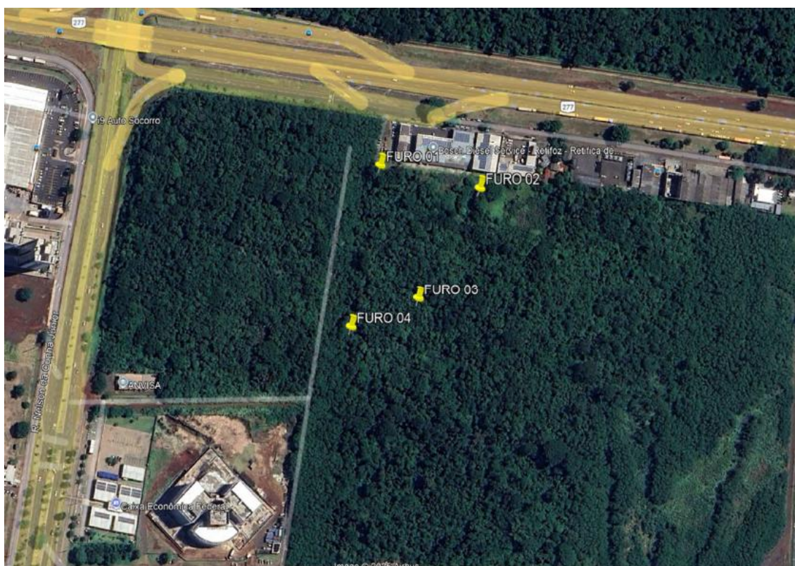
Figura 1 - Planta de locação dos pontos de sondagem
