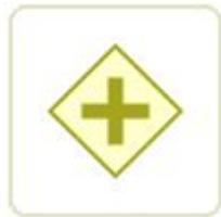
**Gateway paralelo:** Funciona como um “E”, pois quando utilizado indica que, todos os caminhos devem ser seguidos simultaneamente, utiliza-se o mesmo gateway quando a sincronização dos fluxos for necessária.
